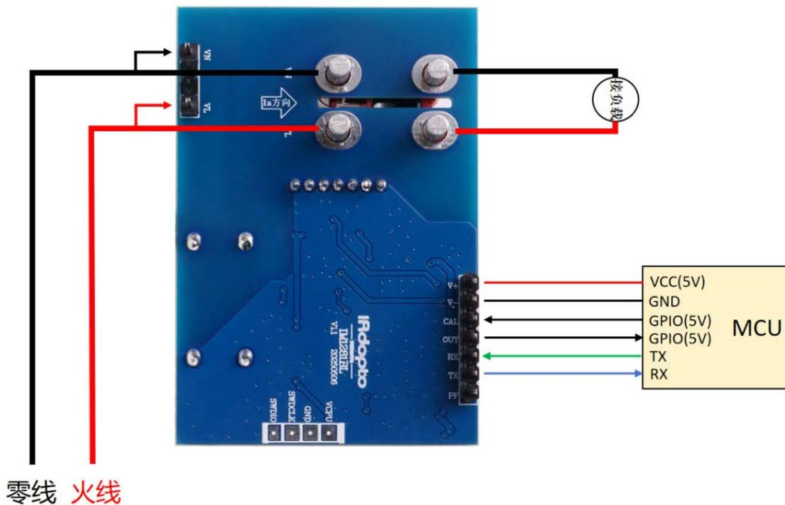
IM1281BL 脉冲检测接口接线示意图
