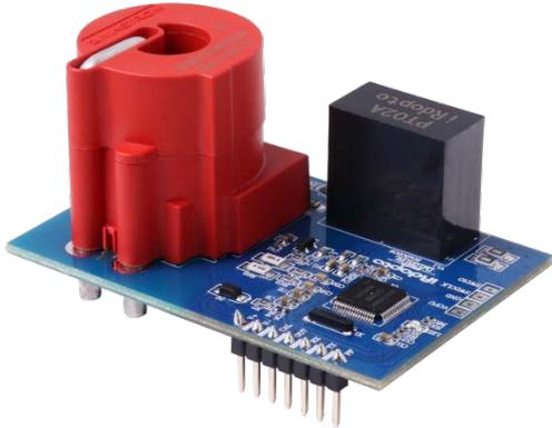
IM1281BL 电测计量及漏电模块是深圳市艾锐达光电有限公司为解决设备制造商对用电设备的用电情况和漏电进行监测而研发的嵌入式模块；作为汽车充电保护、生产自动化检测、路灯监控、节能改造、智能用电管理、设备能耗检测等诸多行业设备的电测计量及漏电检测专用的配套模块。
